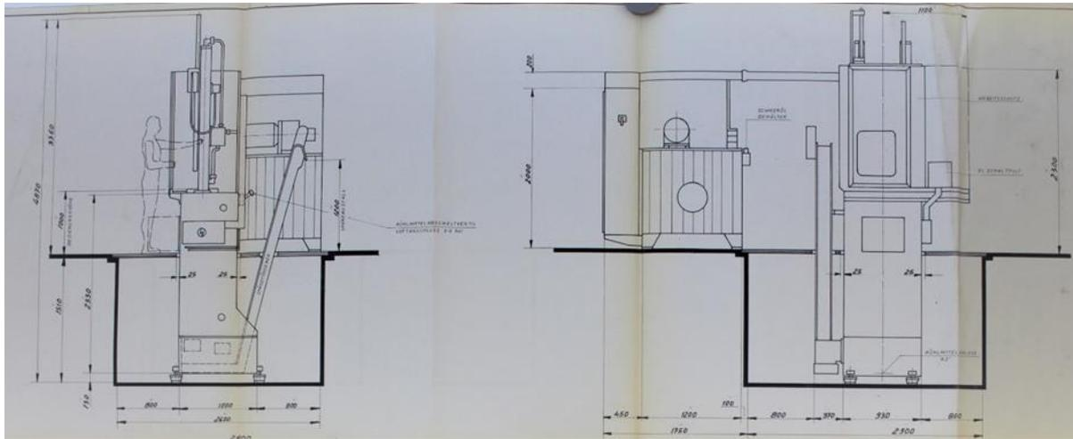
Seiten- & Vorderansicht Maschinenaufstellplan mit Grube
