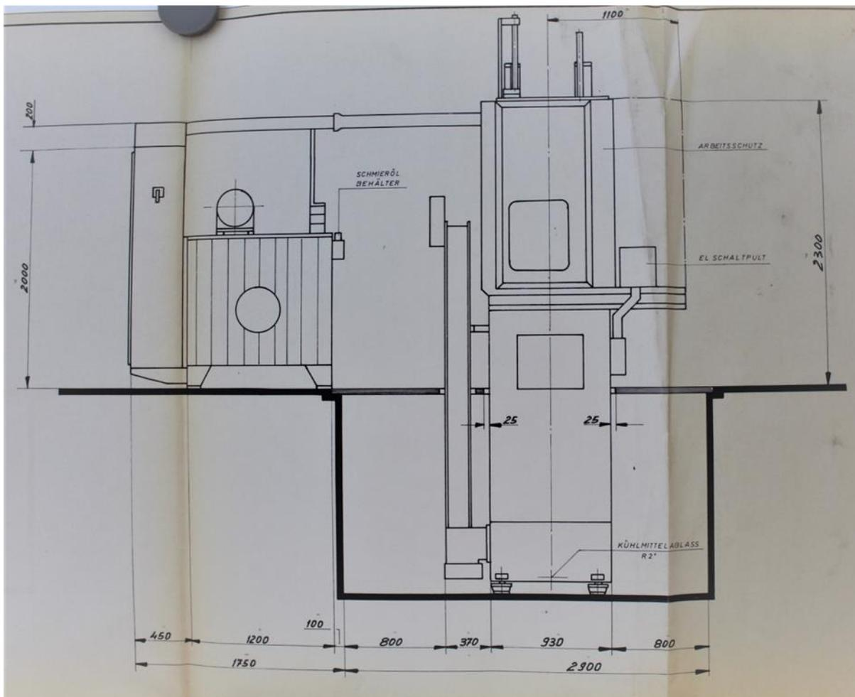
Vorderansicht Maschinenaufstellplan mit Grube
